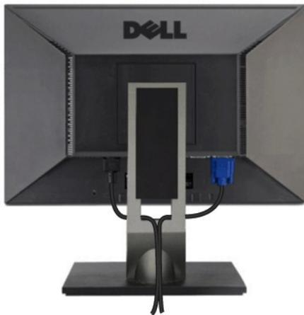
Dopo aver fissato tutti i cavi al monitor e al computer, (Si veda [Collegamento del Monitor](#) per i collegamenti dei cavi,) usare il passacavi per organizzare i cavi in maniera ordinata, come mostrato sopra.
